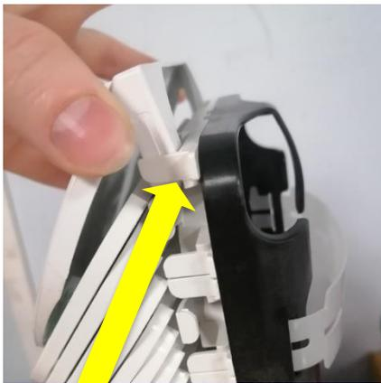
Onglets déclipés, couvercle libre de mouvement et prêt à être retiré.
