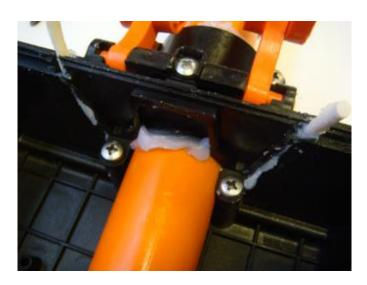
PUSH THE IN-LINE CLAMP INTO POSITION. ENSURE IT FITS CENTRALLY BETWEEN THE FOAM CORD EITHER SIDE TAKING CARE NOT TO MOVE THEM OUT OF POSITION.
