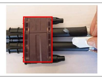
• Lubrifier les extrémités du câble de manière homogène.
