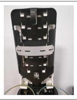
• Bien séparer les deux extrémités de la boucle avant de la former à l'extérieur du MMJ. Son diamètre est tel que la boucle peut être disposée le long du guide dans zone de stockage.
