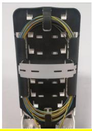
Après installation dans le guide, une seule boucle doit être apparente.
