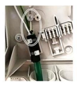
• Inserire il cavo nell'imbocco, assicurandosi che l'elemento di rinforzo del cavo (se presente) si inserisca sotto la vite di tenuta dello stesso uscendo per un breve tratto dalla parte opposta.
