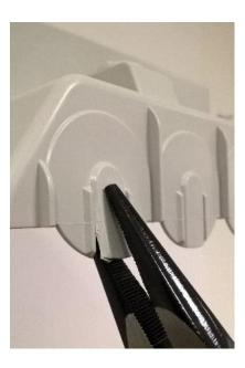
• Rimuovere la protezione dell'imbocco della dimensione desiderata, utilizzando le pinze.
