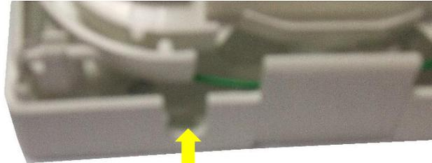
Retire el slot usando alicates
